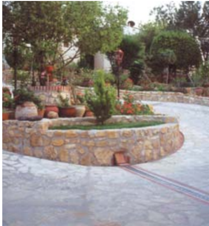
(الشكل ٢٥): استخدام السطوح المرصوفة كجزء من نظام لتجميع مياه الأمطار إذ تقوم بتجميع مياه الأمطار وتوجيهها إلى مناطق التخزين.
