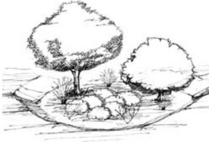
(الشكل ٢٤): قد تكون مناطق حفظ المياه في الموقع من مناطق منخفضة ومحفورة في الأرض تمكن النباتات من الاستفادة من مياه الأمطار التي تتجمع فيها بدلاً من أن تتساقط تلك المياه إلى مناطق أخرى في الموقع.
